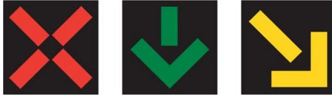
2.65 Lichtsignal-System für die zeitweilige Sperrung von Fahrstreifen (Art. 68)
